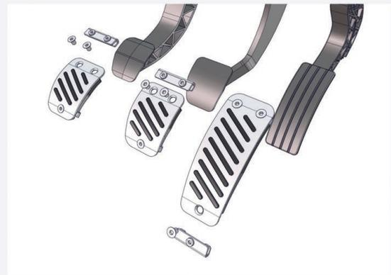
2. Открутить винты (инструмент - шестигранный ключ 3) накладок как изображено на рисунке (по 2 винта сверху на накладках педалей сцепления и тормоза, и один винт снизу накладки педали газа).
