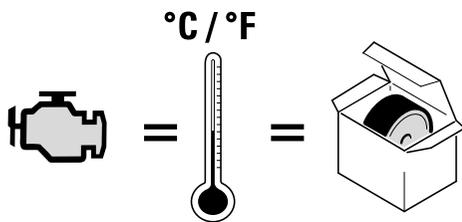
Температура двигателя при монтаже должна быть равна температуре ролика, примерно 22\*.
