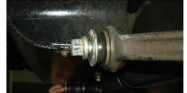
Удерживая нажимным ключом 19 головку болта нижнего рычага, открутите нажимным ключом 24 гайку, до образования зазора между шайбой и гайкой 7мм.
