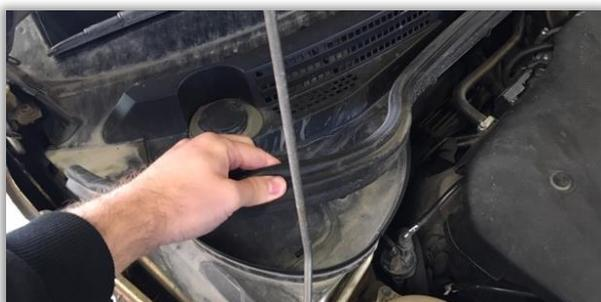
3. - Снять жабо, открутив по периметру 6 самонарезающих винтов крепления накладки рамы ветрового окна (Torx T20)
