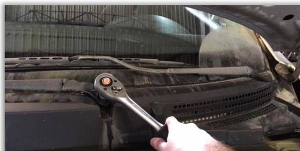
4. - Открутить 6 болтов крепления верхней опоры. (ключ на 13)
