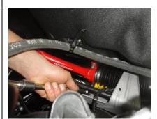
Установить усилитель щитка передка, затем прикрутить 2 гайки M8.
