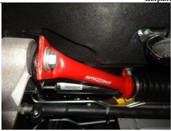
Затянуть все болты и гайки.
