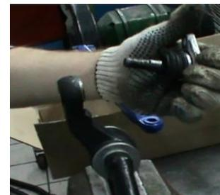
Отсоединить рычаг от шаровой опоры
