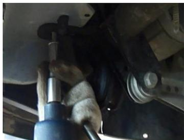
Открутить болты М12 крепления поперечины.
