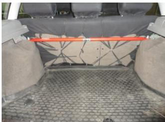
**4. Зажмите гайки М12, прикрутите саморезы крепления обивки и установите полку багажника.**
