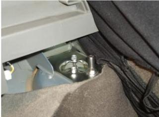
**2. Опустите диск в углубление опоры с наживленными болтами М6. Для равномерной посадки подстучите молотком. при этом полукруглые шляпки болтов должны зацепиться за отбортовку на диске.**
