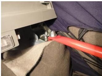
**3. Слегка подтяните гайки М6 (если затяжка идет с перекосом, необходимо ослабить гайки и завести полукруглые шляпки болтов за отбортовку). Оденьте трубу на шпильки М12, затяните гайки М6. Вставьте трубу с двух сторон, а затем посадите на шпильки.**
