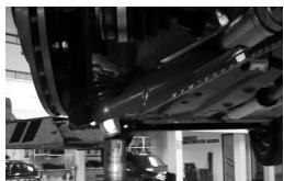
Окончательную затяжку гаек - М 24 с моментом 18кг\м, М30 с моментом 20кгс\м, М16 на растяжке 16,0-18,0 кгс\м производить при поджатом рычаге, например гидравлической стойкой, как показано на рисунке. После затяжки необходимо застопорить гайки с помощью шайб, входящих в комплект.
